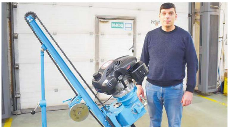
▲ Начальник экспериментального цеха А. Колосов демонстрирует новейшую установку для бурения малогабаритных скважин
