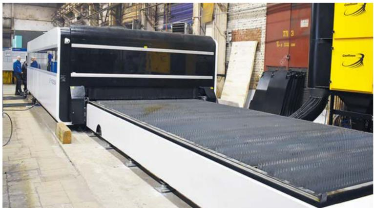
▲ Перспективнейший станок для лазерной резки металла проходит настройку
